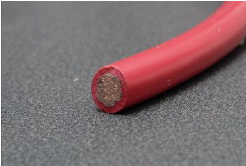
afb. 10 Correct geknipte kabel
