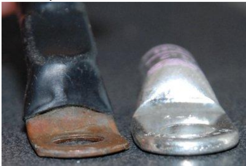
afb. 5 Twee kwaliteiten kabelschoenen
