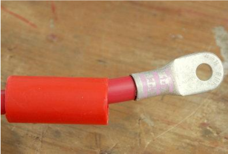
afb. 15 eerst krimpkous aanbrengen
