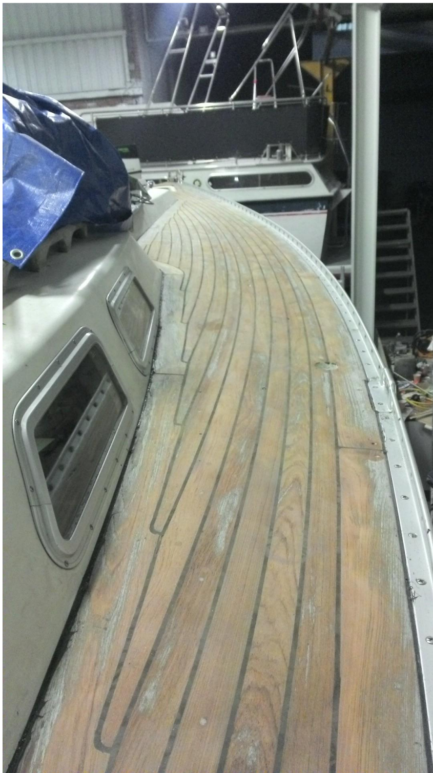
afb. 19 Klaar voor montage van het beslag
