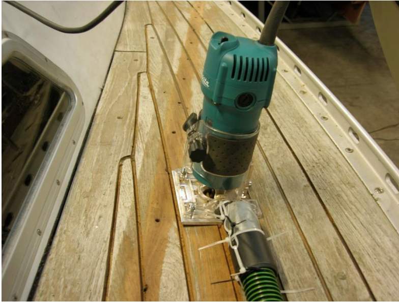
afb. 11 Frees met stofzuigerslang, voor afzuigen materiaal
