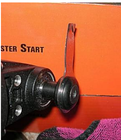
afb. 5 Fein mesje voor verwijderen rubber
