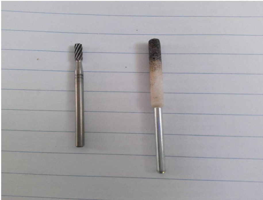
afb. 13 Dremel frees (3,2 mm) en slijpsteentje (4 mm)
