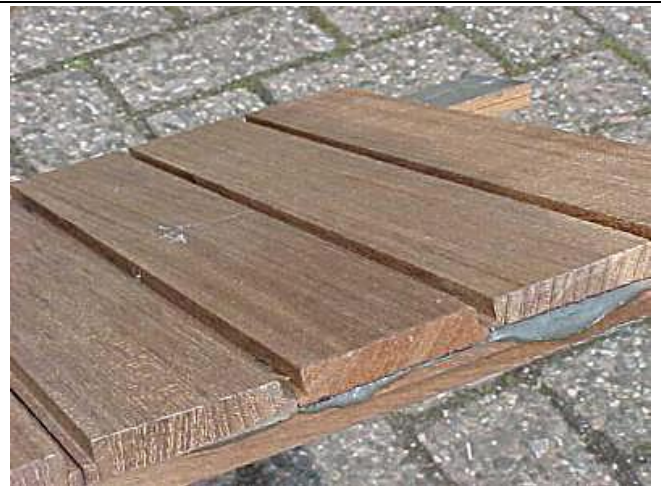
Afb. 1 Teakdelen van de Arnhemse Fijnhouthandel, 9 x 48 mm, met tweezijdig een kitsponning
