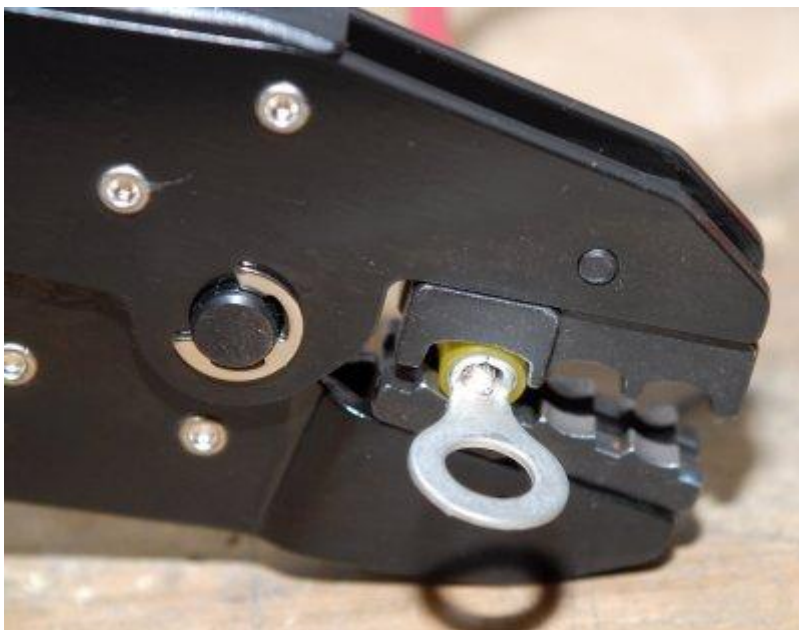
afb. 26 Geïsoleerde kabelschoen in de dubbelkrimptang
