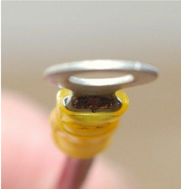
afb. 28 Meer zicht op gelijkmatige klemming
