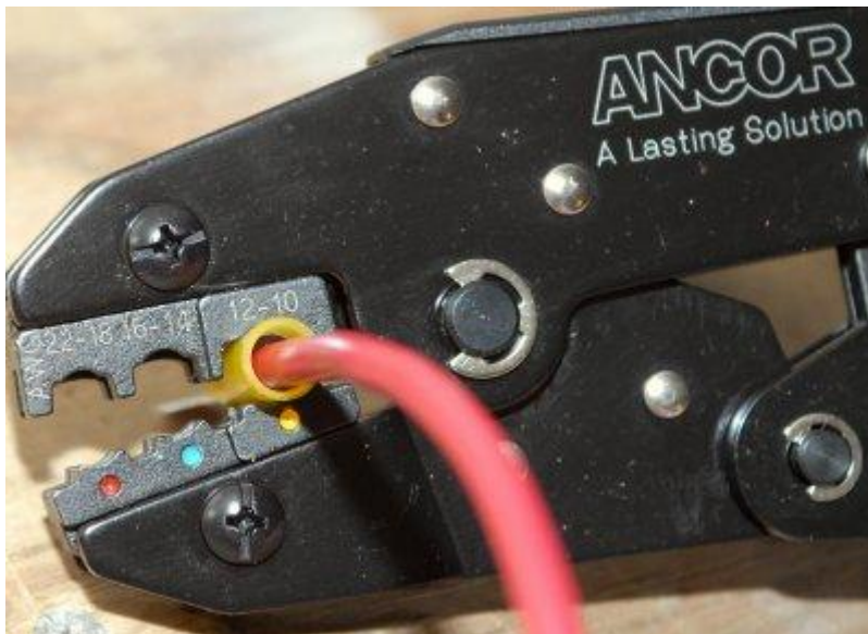
afb. 24 Krimptang voor geïsoleerde kabelschoenen
