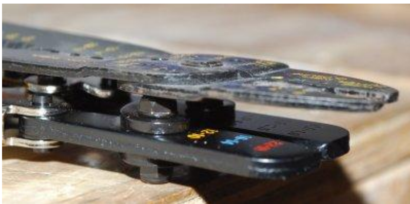
afb. 4 Vergelijking van tangbekken op dikte
