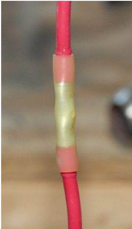
afb. 23 De lijmende krimpkous is door verwarmen gekrompen en gelijmd
