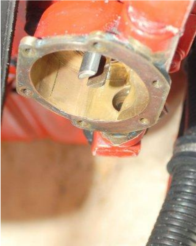
Afb. 10 Controleer de binnenkant van de pomp
