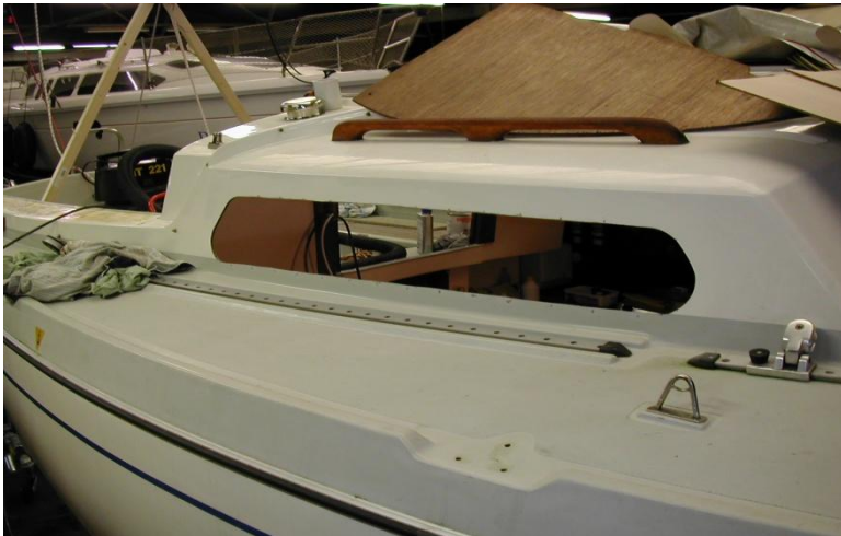
afb. 1 een V 822, oude ramen verwijderd en nieuwe vorm gezaagd
