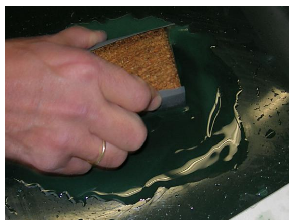
fig. 8 Schuren met een kurkblokje
