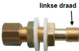
afb. 6 Schotdoorvoer gasbun, met aan de rechter kant linkse draad, en de andere kant rechtse draad en een moer
