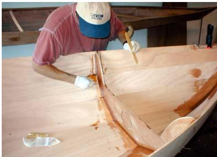
afb. 5 Het aan elkaar lijmen van houten delen
