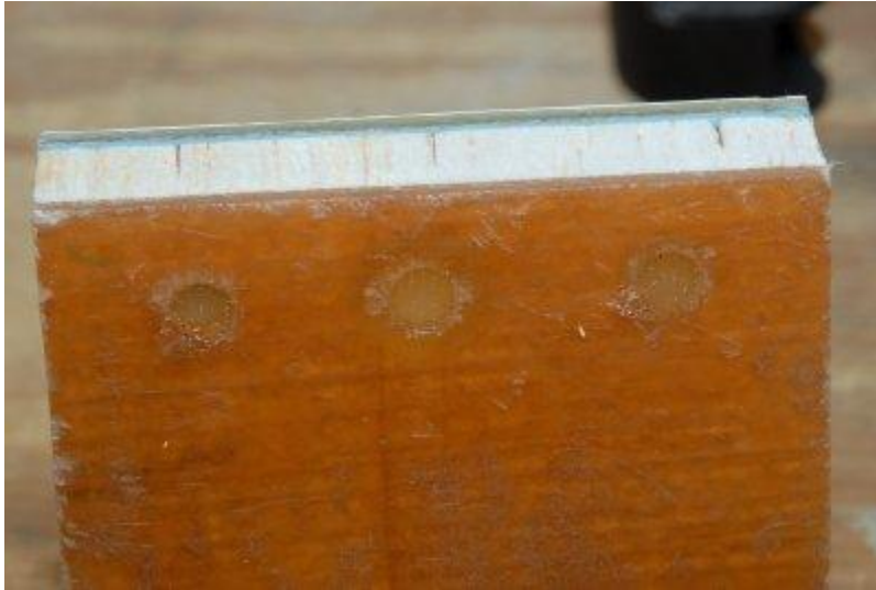
afb. 15 Onderkant dek - gevuld met epoxy
