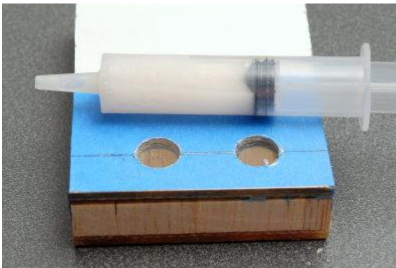
afb. 13 Tape over de gaten
