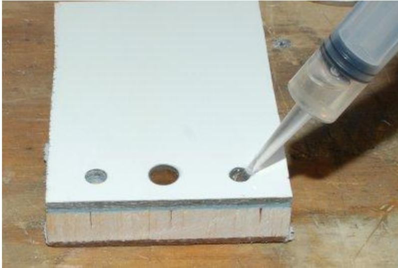
afb. 10 Niet verdikte epoxy injecteren
