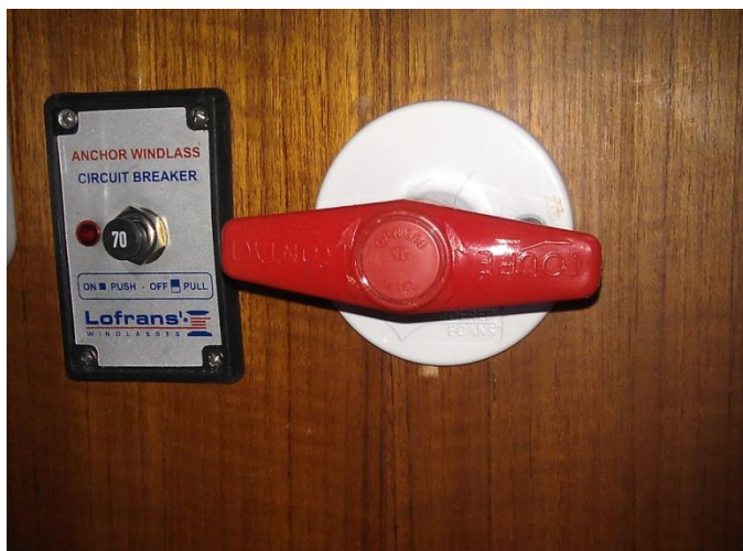
afb. 28 Bedieningskant: thermische zekering en hoofdschakelaar
